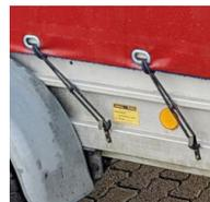
**Tipp:** Für ein optimales Abspannen der Plane empfehlen wir, die Haken leicht seitlich versetzt zu den Ösen anzubringen – auf der linken Seite (von der Mitte aus gesehen) nach links und auf der rechten Seite nach rechts.
